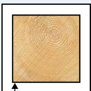
Bei Beflammung Temperaturerhöhung hinter der Bekleidung max. 270 K (250 K im Mittel).
